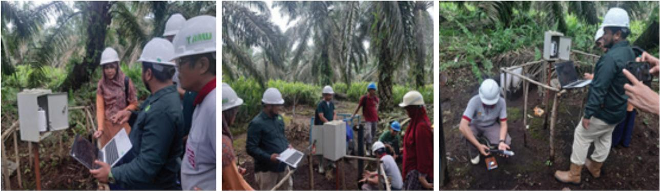
Proses pengecekan dan reinstall alat perekam kelembaban tanah
