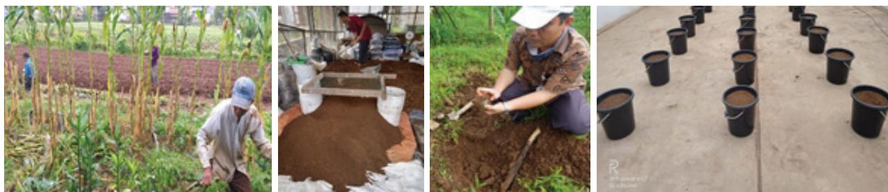
Survei lokasi lahan untuk pengambilan tanah dan contoh tanah utuh di Kec. Dramaga, Bogor, prosesing tanah, dan contoh tanah yang telah diprosesing
